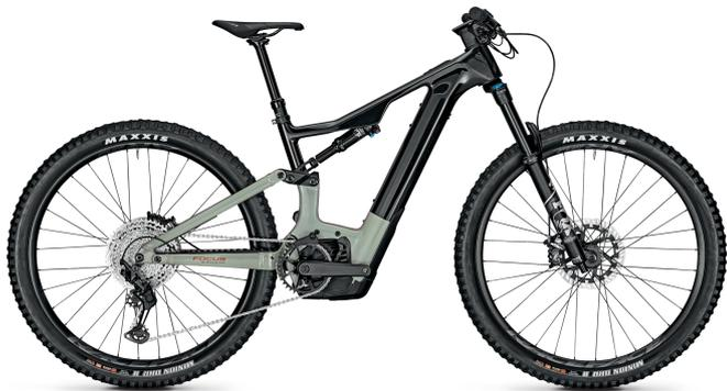
Das JAM<sup>2</sup> gliedert sich zwischen unserem E-Enduro FOCUS SAM<sup>2</sup> und dem THRON<sup>2</sup> ein. 150 mm Federweg ermöglichen es dem JAM<sup>2</sup>, fast überall zu fahren.
